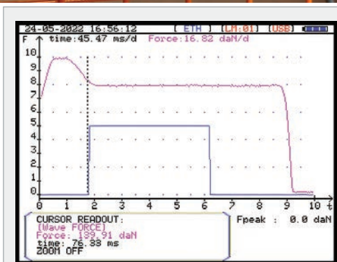
Visualizzazione della forza e del passaggio della corrente. Force and current timing.
